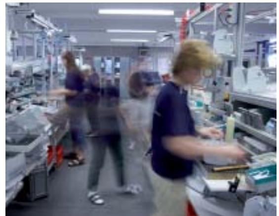
Das «Einstückfluss» Prinzip bei Noventa AG: Montage eines Handtuchspenders in einem Arbeitsprozess vom Einzelteil bis zum verpacktem Endprodukt.
